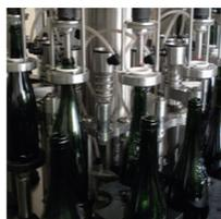
Assure un niveau conforme en limitant la prise d'oxygène.
